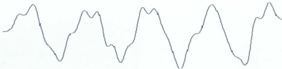
Σχήμα 1.1.2.4: Αναλογικό Σήμα στην Έξοδο του Δέκτη (Αλλοιωμένο)
