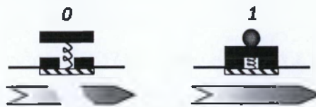
Σχήμα 3.6: Λογικές καταστάσεις ενός διακόπτη
