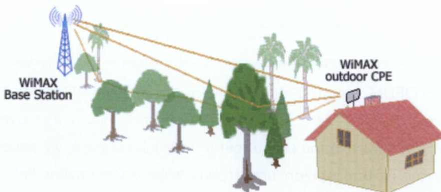
Σχήμα 8. Σύνδεση NLOS (Το σήμα φτάνει στον δέκτη μέσω αντανάκλασεων και διασποράς)
