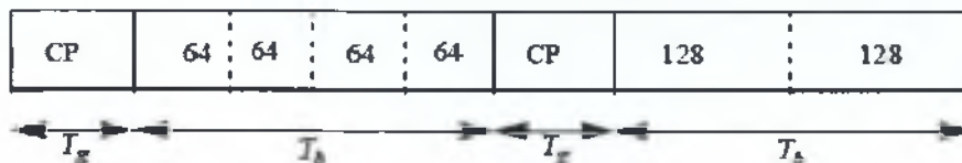
Σχήμα 11 : Δομή προπομπού DL και αρχικός κυμαινόμενος προπομπός
