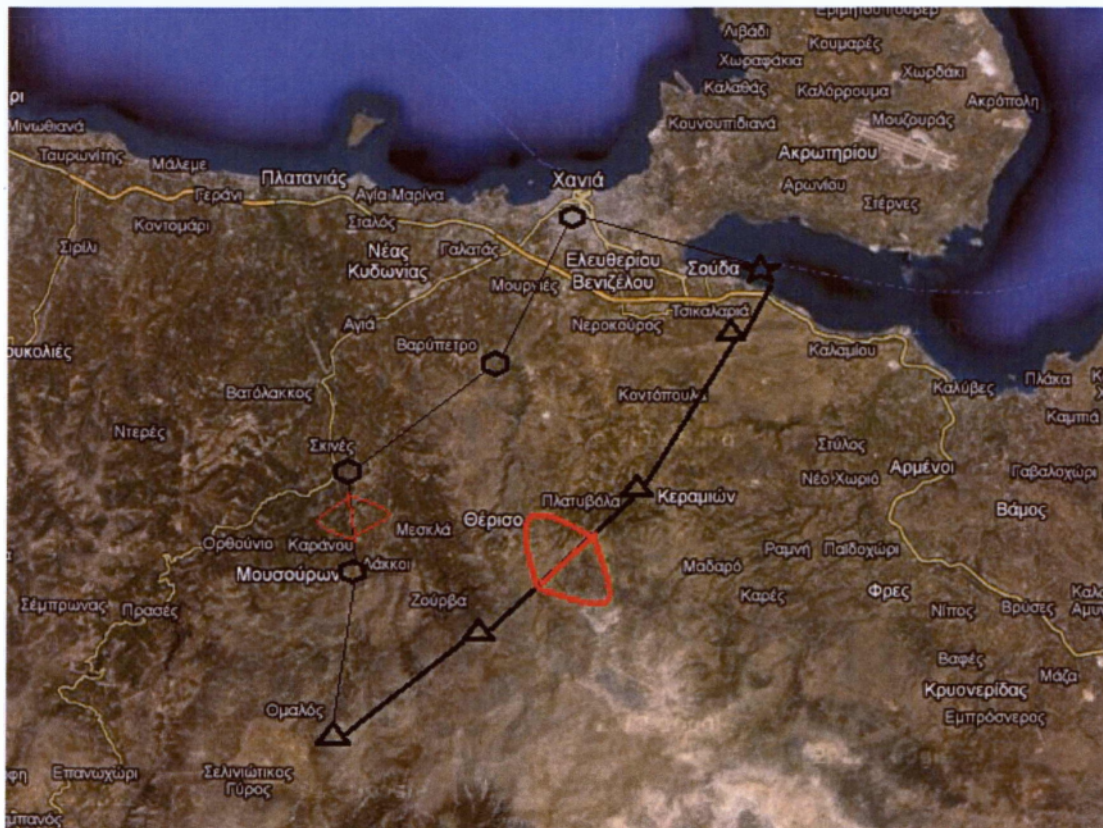
Σχήμα 35: Σενάριο λειτουργίας για την Ανώνυμη Ναυτιλιακή Εταιρεία Κρήτης (A.N.E.K. LINES). Με τρίγωνο παρουσιάζονται οι σταθμοί βάσης της κύριας διαδρομής, με εξάγωνο οι σταθμοί βάσης της εφεδρικής και με αστέρι ο CPE (δέκτης).
