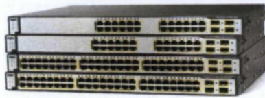
Εικόνα 7 Μεταγωγείς Cisco Catalyst 3750
