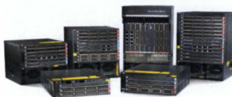
Εικόνα 10 Μεταγωγείς Cisco Catalyst 6500
