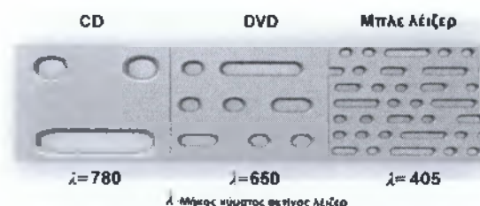
Εικόνα 6-Η εξέλιξη των οπτικών δίσκων και η αύξηση της χωρητικής τους ικανότητας
