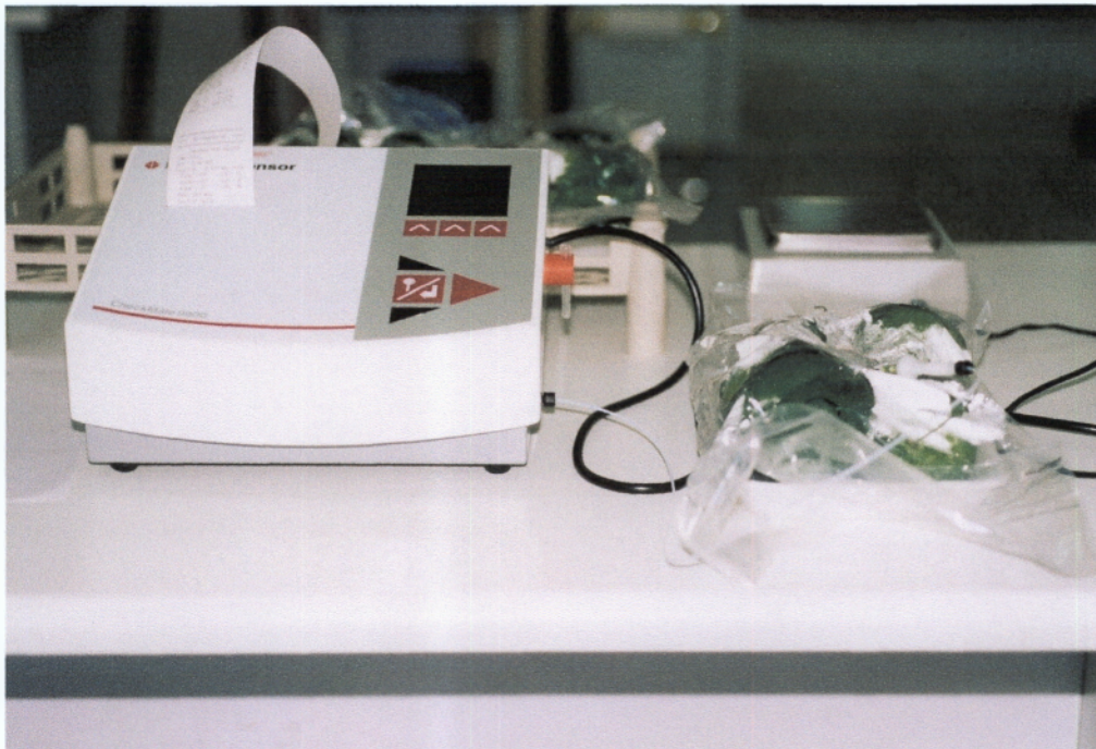
Εικόνα 3. Όργανο προσδιορισμού σύνθεσης ατμόσφαιρας (% O 2 , %CO 2 ) των πλαστικών συσκευασιών
