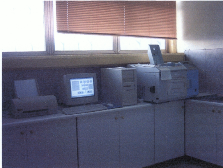
Εικόνα 4. Αέριος χρωματογράφος για τον προσδιορισμό του αιθυλενίου στην ατμόσφαιρα των συσκευασιών πιπεριάς
