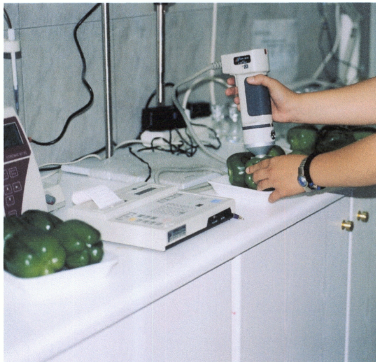
Εικόνα 6. Χρωματόμετρο για τον προσδιορισμό του χρώματος σε συσκευασμένες και μη πιπεριές
