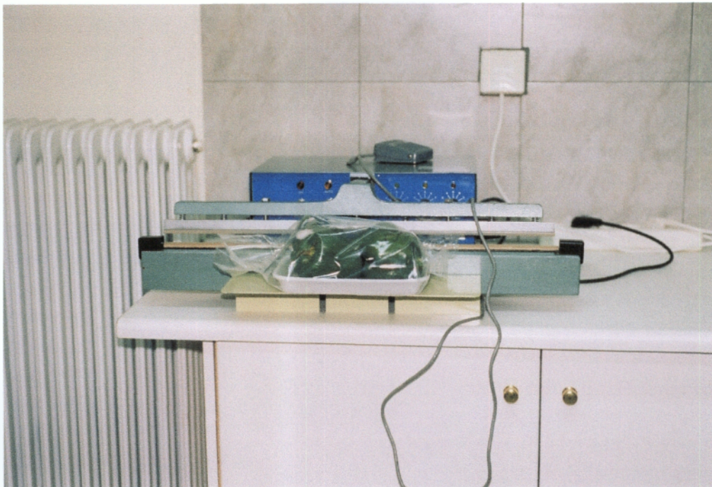
Εικόνα 1. Θερμοσυγκολλητική μηχανή για το κλείσιμο των συσκευασιών
