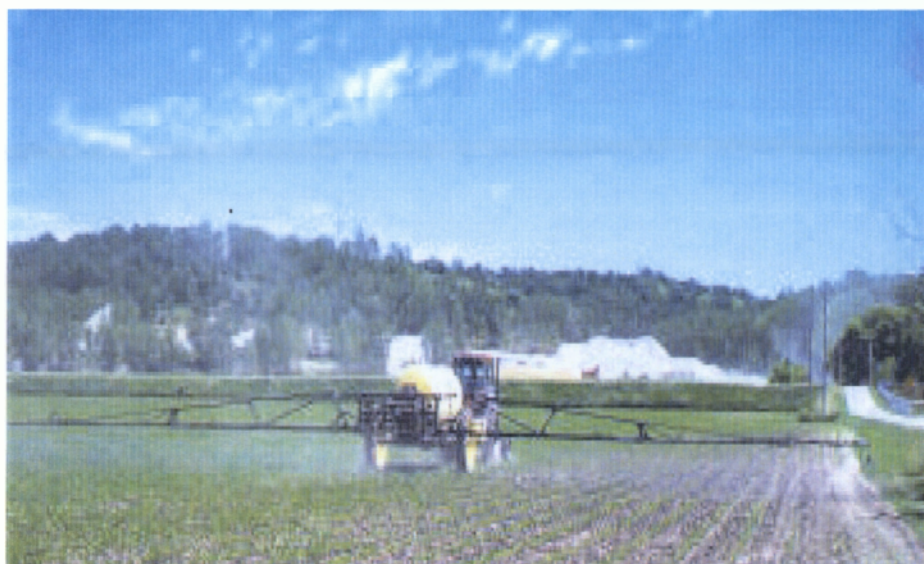
Ψεκασμός καλλιέργειας με ειδική φερόμενη από τον γεωργικό ελκυστήρα ψεκαστική μηχανή Σχήμα 4.2.4
