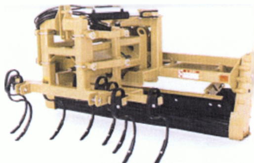
Καλλιεργητής με πνευματικό σύστημα ανύψωσης συνδεδεμένος με το γεωργικό ελκυστήρα Σχήμα 2.7.1
