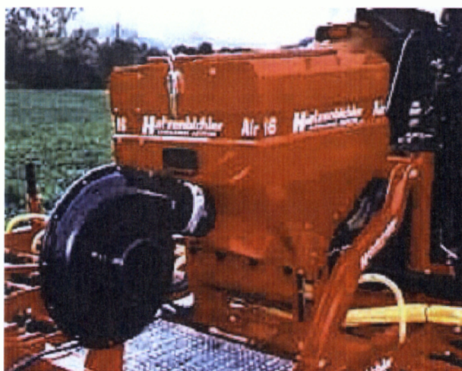
Πνευματικού τύπου σπαρτική μηχανή με αεροστρόβιλο
