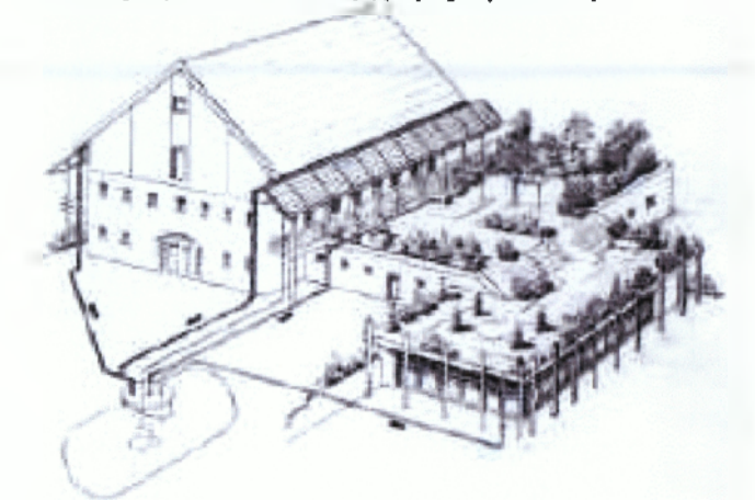
εικόνα 10. Άρδευση και αποθήκευση ύδατος σε ένα σύστημα κήπου στέγης
