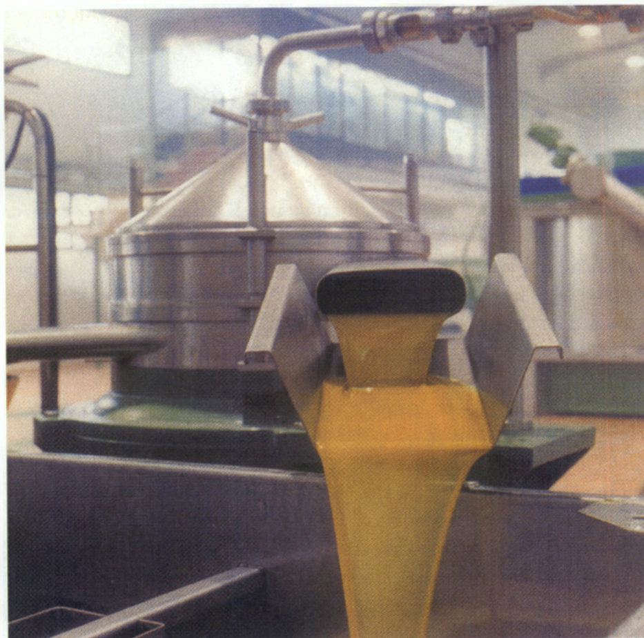
Εικόνα 7. : Ελαιοδιαχωριστήρας κάθετης διάταξης. (25).
