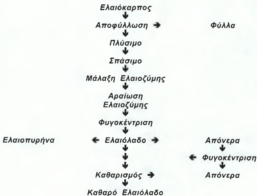
Σχεδιάγραμμα : Στάδια επεξεργασίας ελαιόκαρπου σε ελαιουργείο φυγοκεντρικού τύπου. (Περιοδικό : Γεωργία – Κτηνοτροφία 5, 1996).
