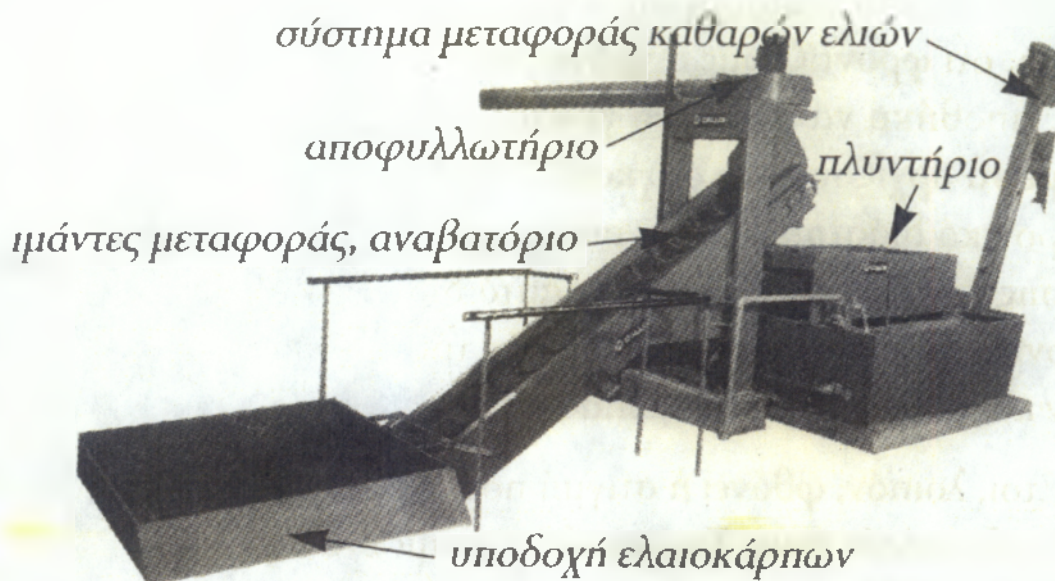
Εικόνα 1. : Ελληνικής κατασκευής πλυντήριο ελιών της εταιρείας Καλλής. (22).
