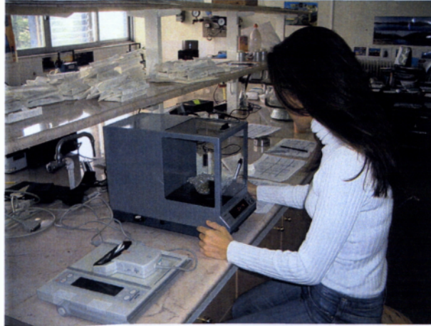
Φωτ. 11. Πηλείδου Μ. Μέτρηση ξηρού βάρους βλαστών, κλαδιών και ριζών με ηλεκτρονικό ζυγό
