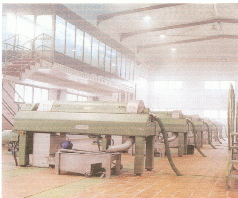
Εικόνα 37: Decanters διαχωρισμού ελαιόλαδου από τα άλλα συστατικά της ελαιοζύμης (Κυριτσάκης Α., 2000)
