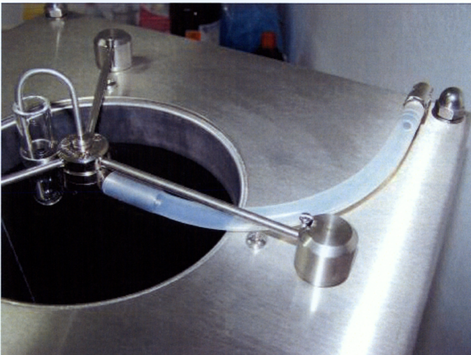
Εικόνα 4.3. Ψεκαστικό μηχάνημα ακριβείας που χρησιμοποιήθηκε στο πείραμα (Laboratory Precision Spray Potter Tower)
