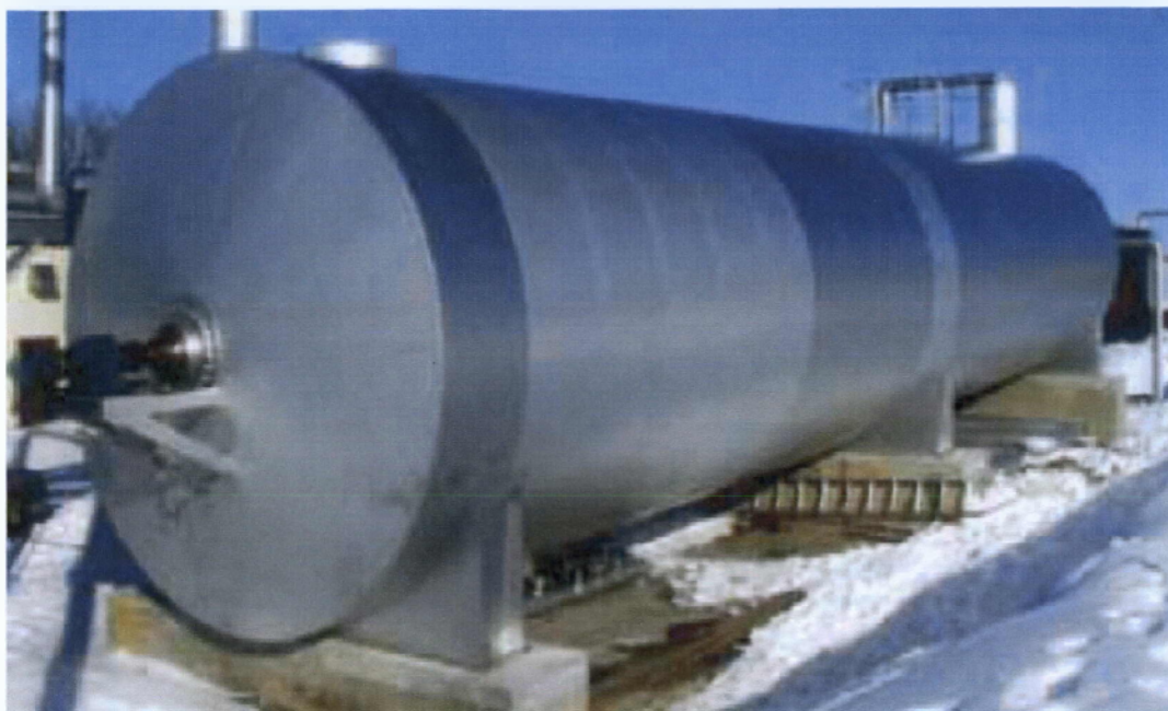
Εικόνα 1: Σχηματική απεικόνιση μιας μονάδας βιοαερίου κλίμακας αγροκτήματος με οριζόντιο χωνευτή από χάλυβα (Hjort-Gregersen,1998)
