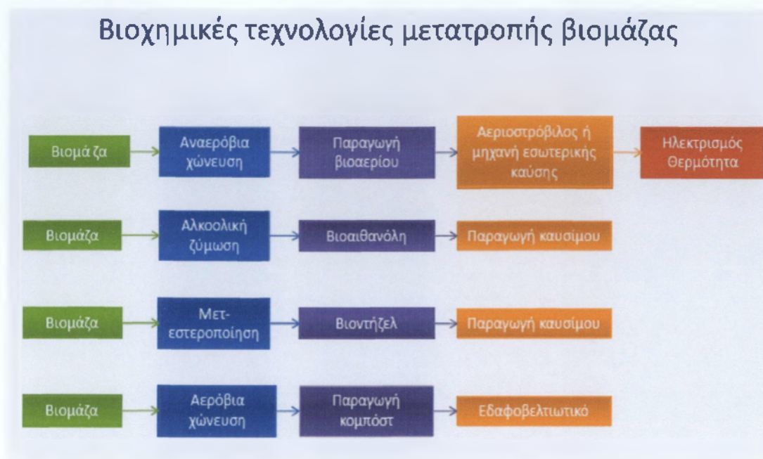
Σχήμα 11: Η μετατροπή της βιομάζας με βιοχημικές τεχνολογίες
