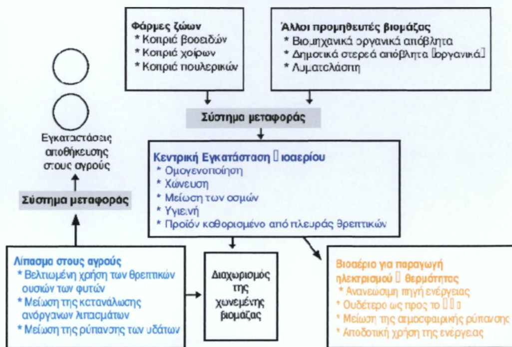
Σχήμα 8: Τα κύρια τμήματα μιας κεντρικής μονάδας συγχώνευσης (Al Seadi et al , 2008)
