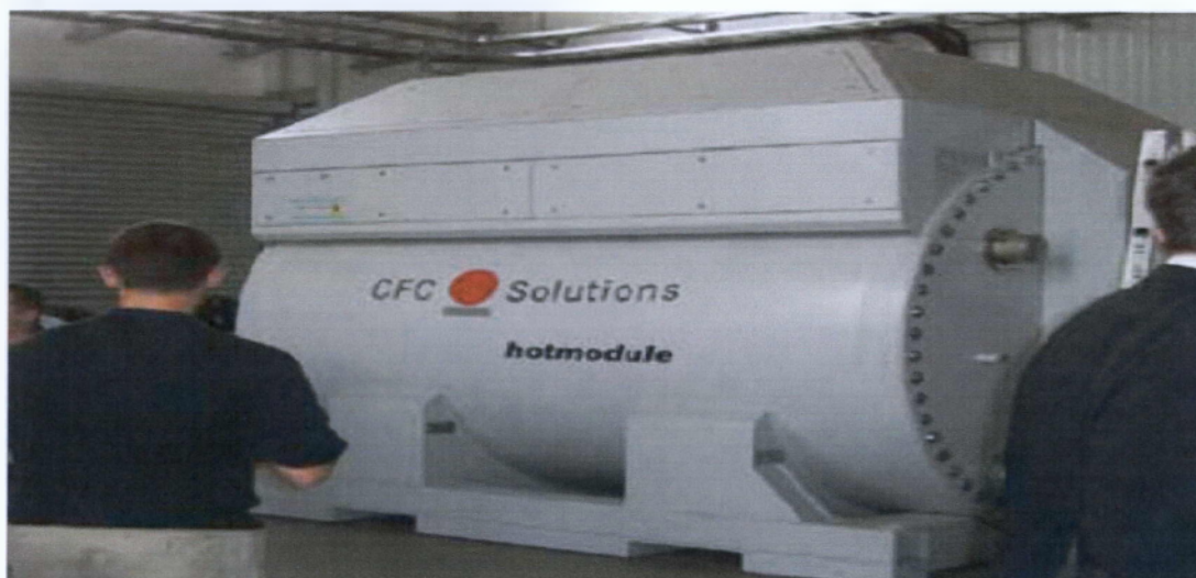
Εικόνα11: Η πρώτη παγκοσμίως κυψέλη καυσίμου τύπου MCFC για βιοαέριο, που λειτουργεί στη Γερμανία (Rutz, 2007)
