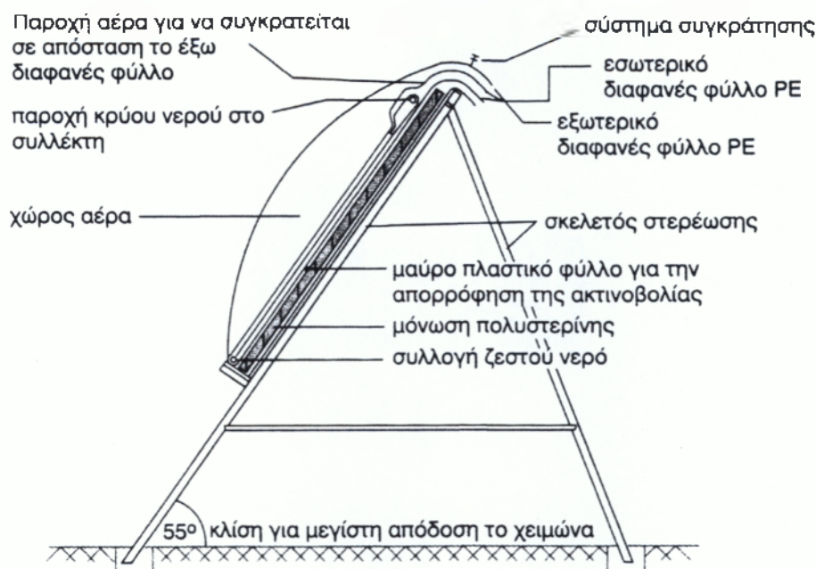
Σχήμα 4.2.1.α. Εξωτερικός ηλιακός συλλέκτης από πλαστικό φύλλο
