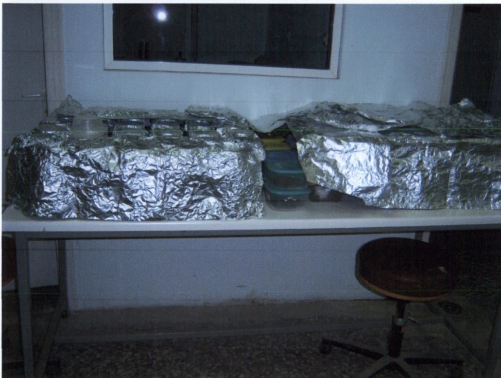
Εγκατάσταση δοκιμής μέτρησης της μεταβολικής( αναπνευστικής δραστηριότητας \text{CO}_2 ) με την χρήση παγίδας \text{NaOH}
