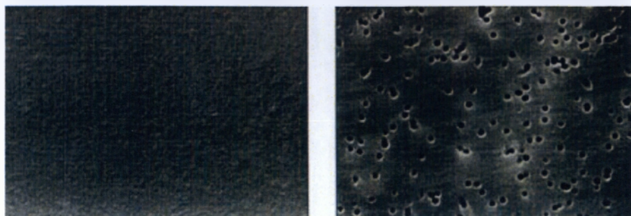
Εικόνα 5: Σύγκριση πόρων αντίστροφης όσμωσης και μικροφίλτρου. (Διαδίκτυο 16)
