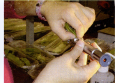
Εικόνα 2.4.5. Τοποθέτηση σταγόνων από το υπό εξέταση δείγμα στο διαθλασίμετρο
