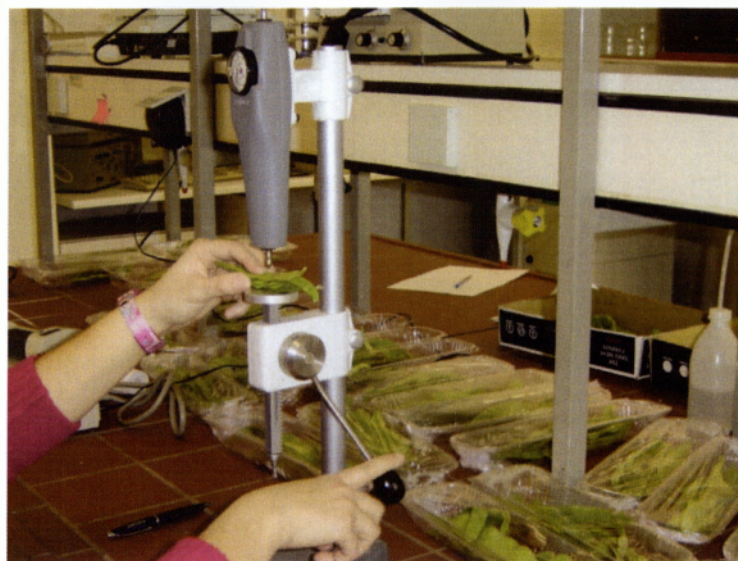
Εικόνα 2.5.2. Χρήση χειροκίνητου συνεκτικόμετρου
