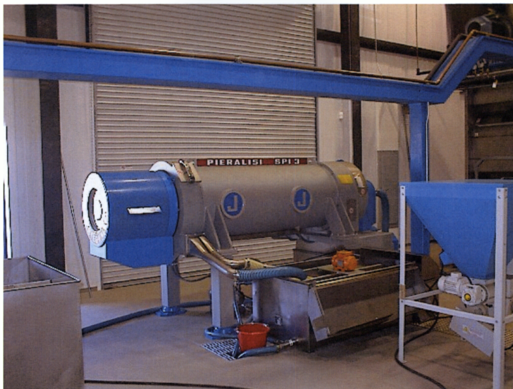
Εικόνα 1.1. Φυγοκεντρικό σύστημα εξαγωγής ελαιολάδου.
