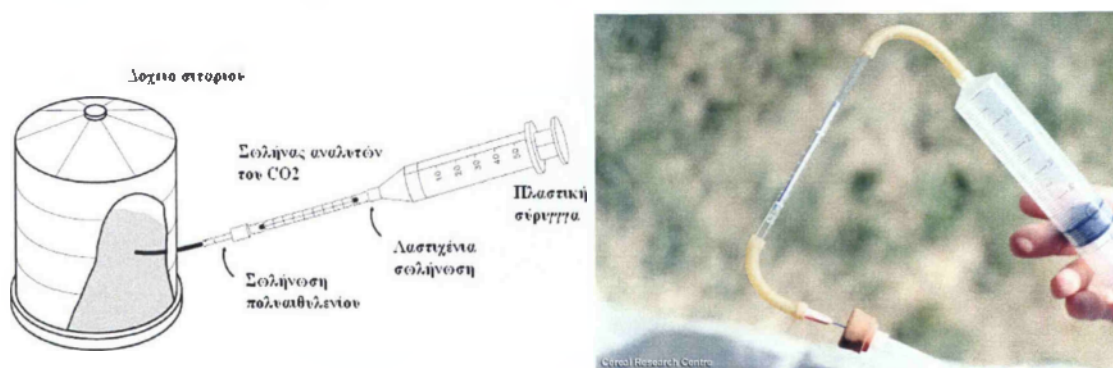
Εικόνα 6.4 Σχηματική διάταξη συσκευής για την ανίχνευση της ποιοτικής υποβάθμισης αποθηκευμένου προϊόντος από τη συγκέντρωση του CO 2 (Πηγή: AAFC, 2000)
