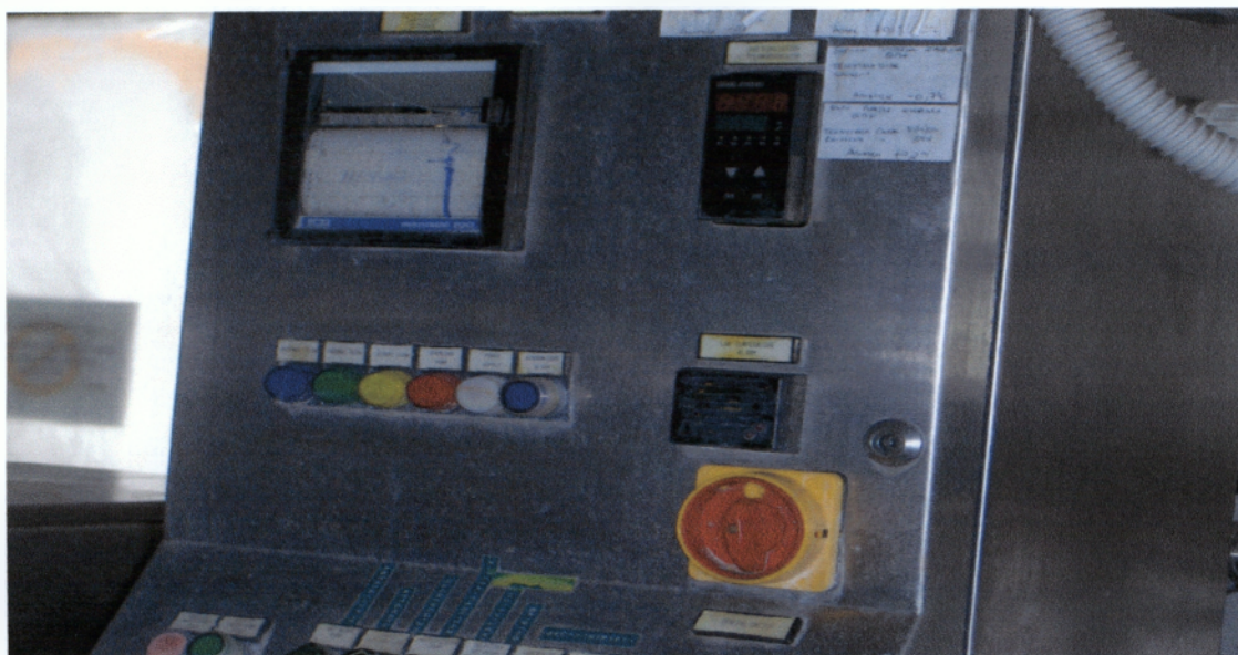
ΕΙΚΟΝΑ 4. Καταγραφικό θερμοκρασίας παστερίωσης του γάλακτος
