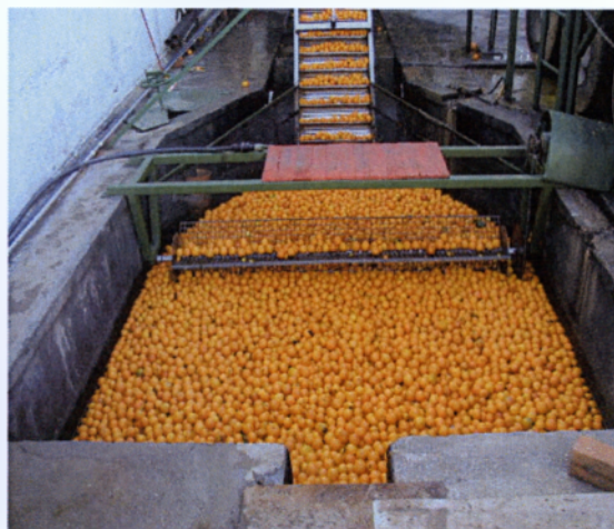
Εικόνα 2.5: Δεξαμενή πλυσίματος [ΑΣΕΧ]
