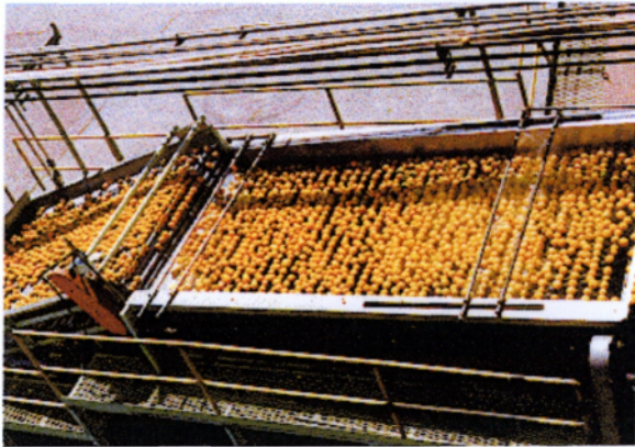
Εικόνα 2.6: Αυτόματο πλύσιμο καρπών κατά την μεταφορά τους [ULTIMATE CITRUS]
