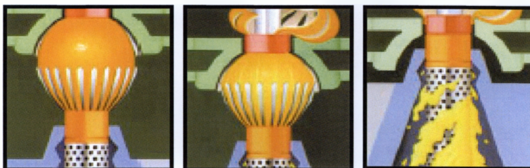
Σχήμα 2.2: Περιγραφή εκχύμωσης ολόκληρου φρούτου σε εκχυματές FMC
