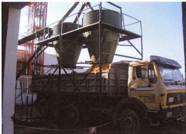
Εικόνα 2.25: Σιλό προσωρινής αποθήκευσης παραπροϊόντων και μεταφορά [ΣΤΑΜΠΕΛΟΣ 2004]
