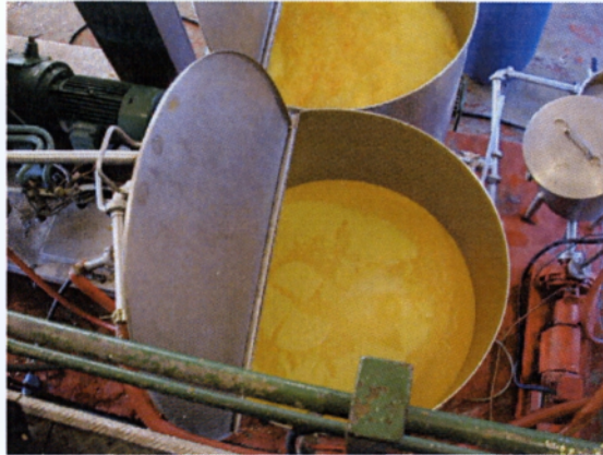
Εικόνα 2.17: Προστάδιο παστερίωσης του χυμού [ΣΤΑΜΠΕΛΟΣ 2004]
