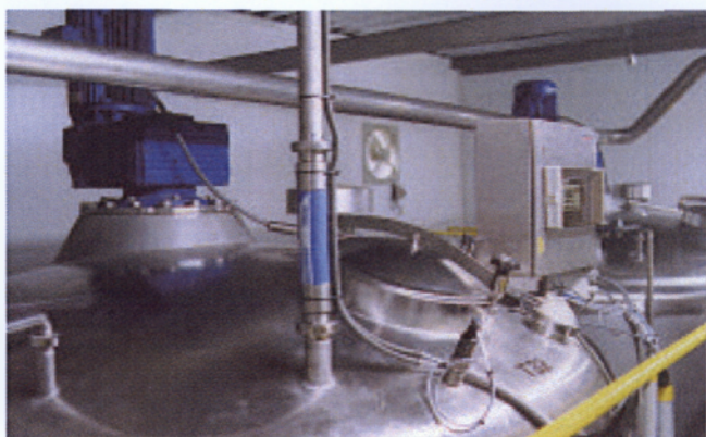
Εικόνα 2.31: Βυτιοφόρο όχημα μεταφοράς ψυγμένου NFC χυμού (πάνω αριστερά), βαρέλι κατεψυγμένου NFC χυμού που αποψύχεται (πάνω) και Δεξαμενή ανάδευσης χυμού NFC (δίπλα) της εταιρίας Louis Dreifus Citrus [LDC]
