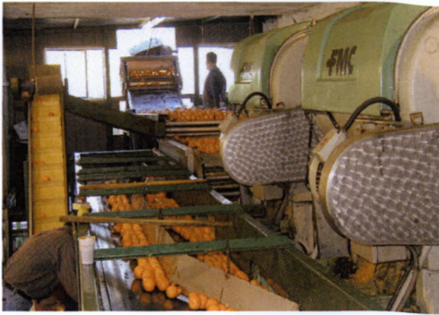
Εικόνα 2.9: Ποιοτική διαλογή και ταξινομητής μεγέθους των καρπών [ΣΤΑΜΠΕΛΟΣ 2004]
