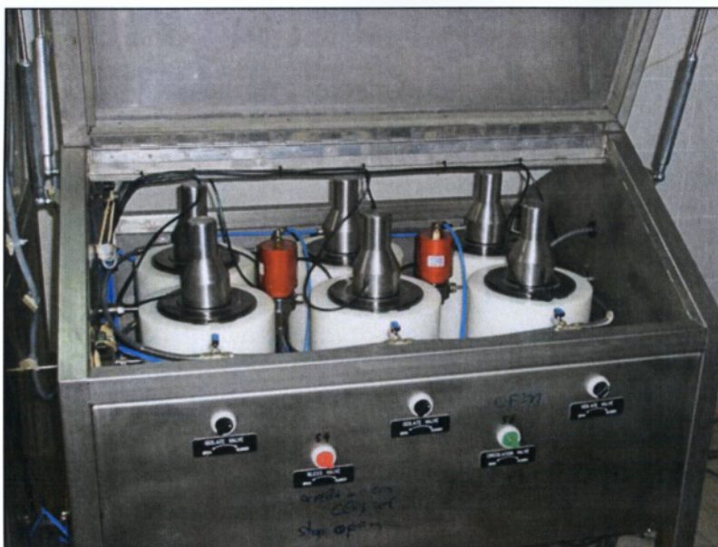
Εικόνα 1. Σύστημα εφαρμογής υπερυψηλής πίεσης εργαστηριακής κλίμακας Food Pressure Unit LO1, (Resato Int. BV, Roden, Holland), η οποία παρέχει τη δυνατότητα μέγιστης πίεσης και θερμοκρασίας λειτουργίας 1000 MPa και 100 °C αντίστοιχα, σε ένα σύστημα έξι μικροθαλάμων (vessels) χωρητικότητας 45 ml ο καθένας.
