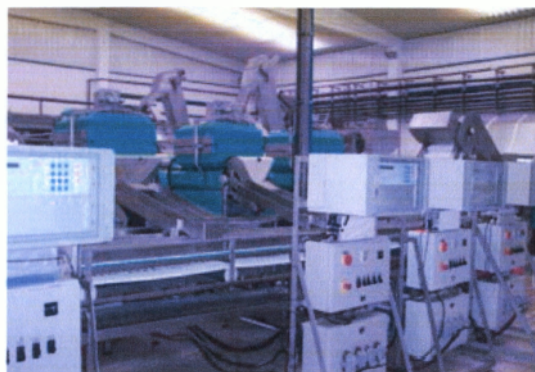
Εικ. 2.12: Μηχάνημα διαλογής με βάση το χρώμα του καρπού
