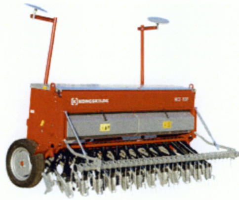
Εικόνα 3.11. Μηχανή γραμμικής κατευθείαν σποράς με τριπλό δίσκο διάνοιξης της αυλακιάς
