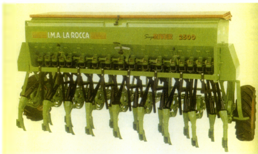
Εικόνα 2.6. Σύγχρονες σπαρτικές με κοινά δοχεία σπόρου, πλάτους ίσου με το πλάτος σποράς.
