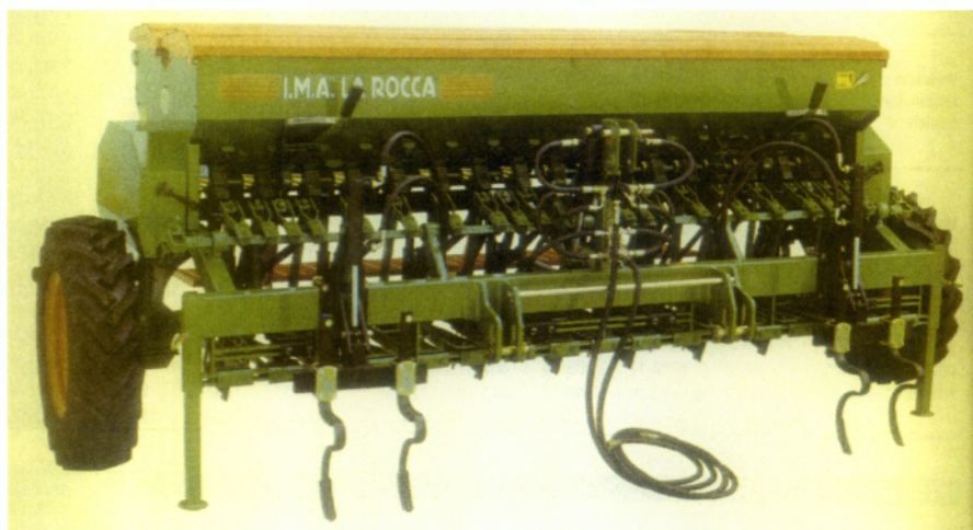
Εικόνα 2.7. Σπαρτική γραμμικών καλλιεργειών με κοινό δοχείο σπόρου (Lely)
