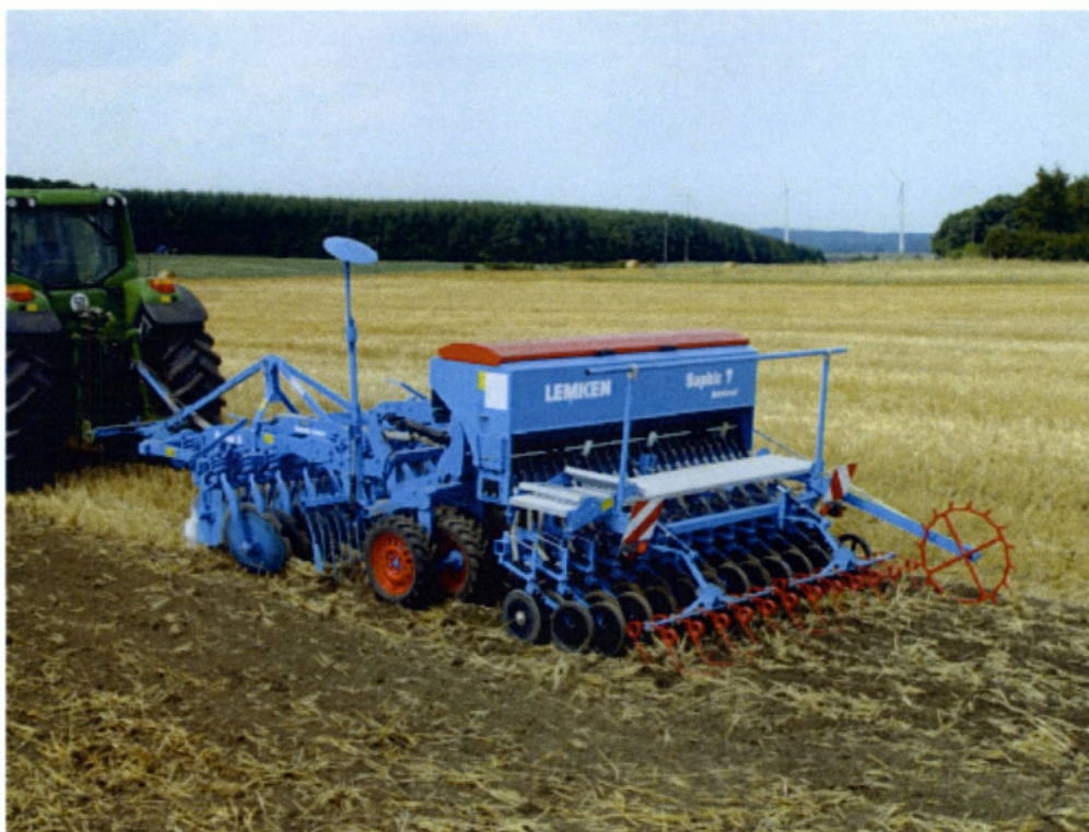
Εικόνα 3.2. Κλασική μηχανή γραμμικής σποράς.
