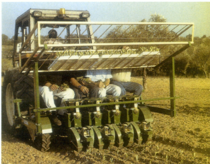
Εικόνα 1.3. Σχηματική παράσταση ημιαυτόματης μηχανής μεταφύτευσης με συγκλίνοντες ελαστικούς τροχούς (Accord).
