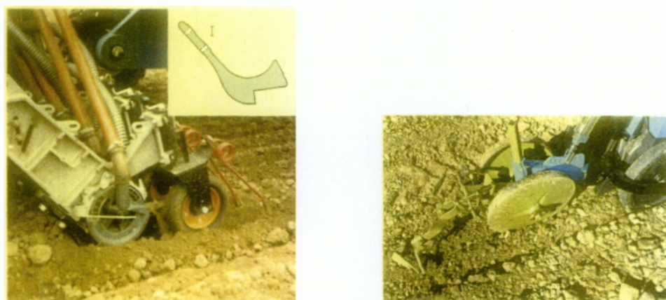
Εικόνα 4.6. Ρύθμιση του βάθους σποράς με τροχούς
