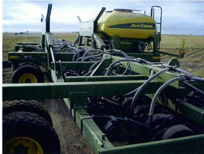
Εικόνα 4.9. Η σπορά γίνεται με ειδικές μηχανές που σπέρνουν με ελάχιστη αναμόχλευση του εδάφους
