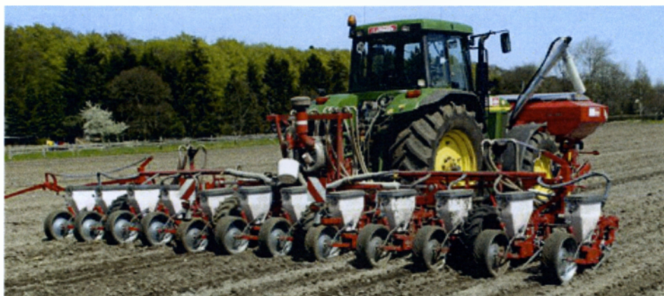
Εικόνα 4.1. Μηχανισμοί πνευματικής σπαρτικής σποράς ακριβείας.
