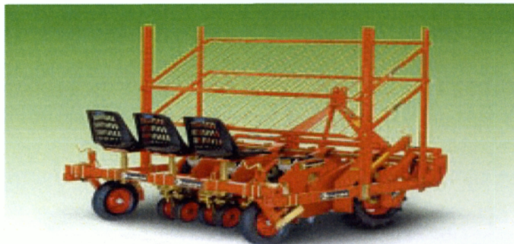
Εικόνα 1.4. Σχηματική παράσταση ημιαυτόματης μηχανής μεταφύτευσης με μεταφορική ταινία και συγκλίνοντες τροχούς (Accord).
