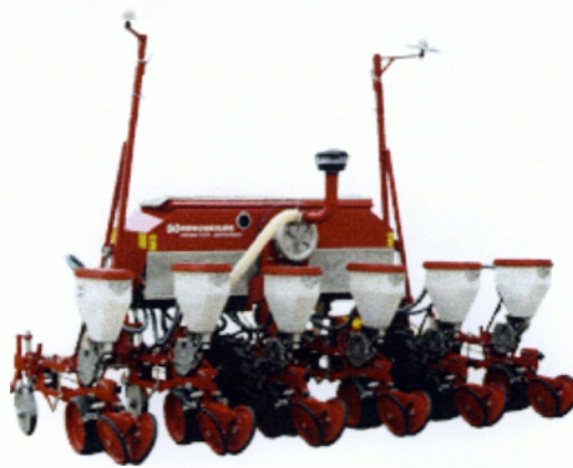
Εικόνα 4.2. Πνευματική σπαρτική ακριβείας.
