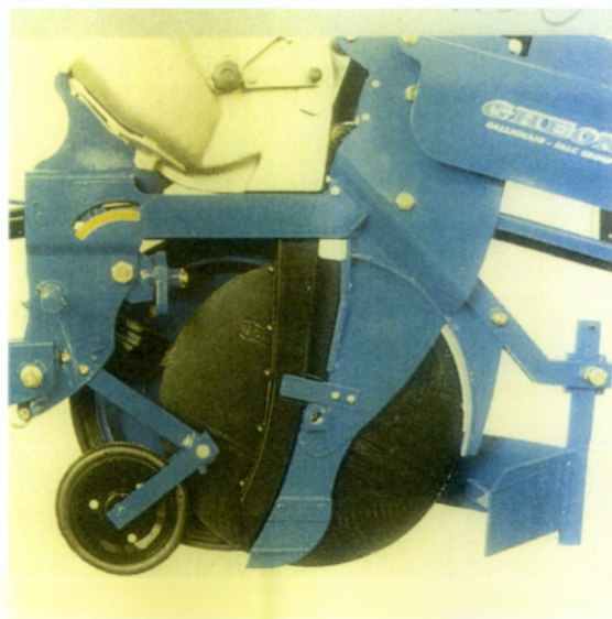
Εικόνα 4.4. Μηχανισμοί διάνοιξης αυλακιάς σπαρτικών μηχανών ακριβείας.
