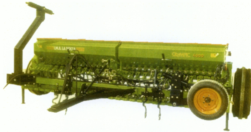
Εικόνα 3.1. Σπαρτική γραμμικής σποράς με τροχούς μεταφοράς
