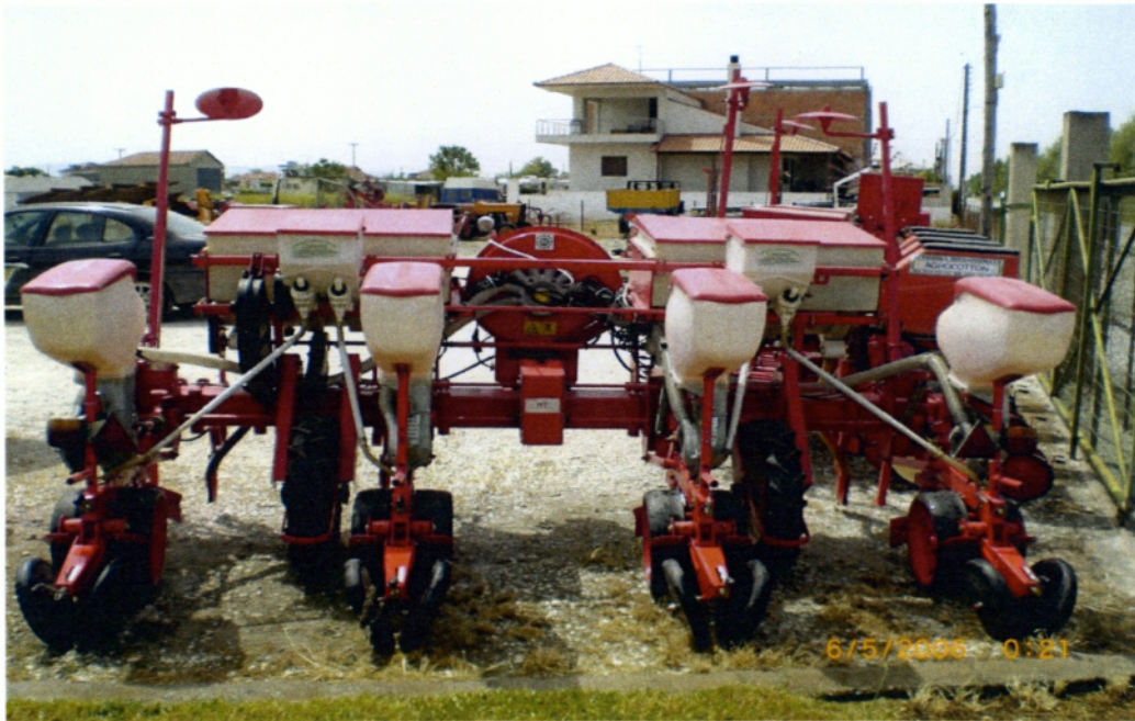
Εικόνα 2.5. Σύγχρονη σπαρτική με ανεξάρτητα για κάθε σειρά δοχεία σπόρου. Η μηχανή φέρει επίσης ανεξάρτητα δοχεία αγροχημικών (πίσω).
