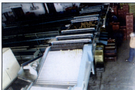
Φωτογραφία 13: Μεταφορική ταινία και μηχανικός ταξινομητής καρπών
