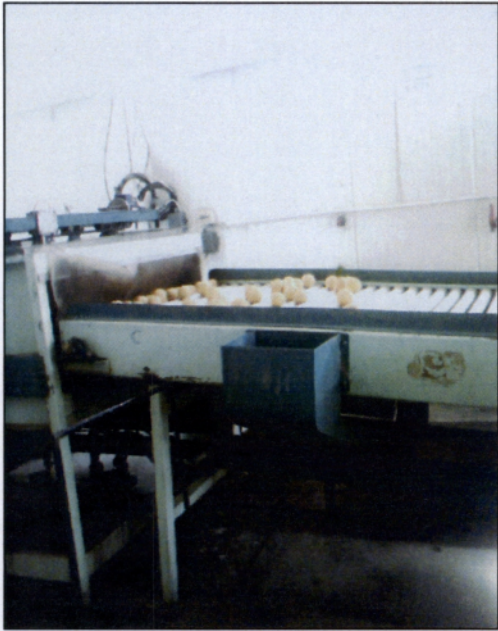
Φωτογραφία 2: Εισαγωγή των καρπών στο πλυντήριο
