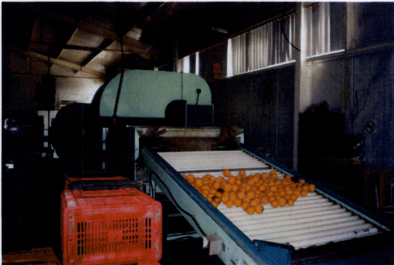
Φωτογραφία 1: Κεκλιμένη τράπεζα προδιαλογής με πασαρέλες
