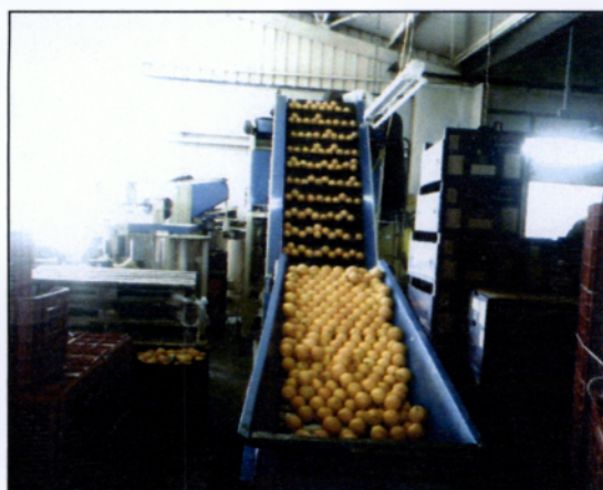
Φωτογραφία 16: Αναβατήριο τροφοδοσίας με τακούνια για τη τροφοδοσία της ζυγιστικής μηχανής
