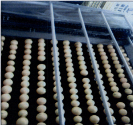
Φωτογραφία 3: Πλύσιμο με μπεκ των πορτοκαλιών και βούρτσισμα
