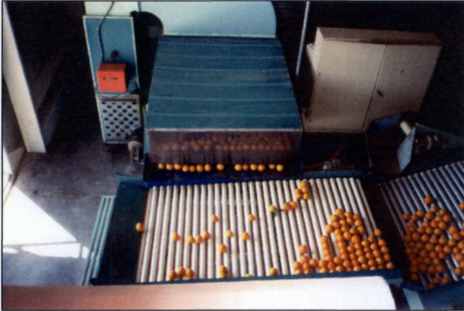
Φωτογραφία 12: Έξοδος των πορτοκαλιών από το στεγνωτήριο στη συλλεκτική ταινία και μεταφορά τους στο μηχανικό ταξινομητή καρπών.
