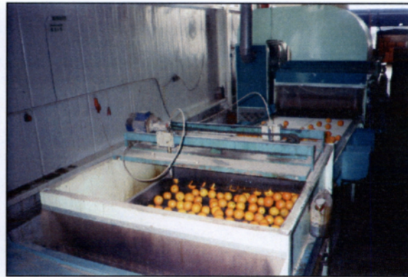
Φωτογραφίες 9 & 10: Μεταφορά πορτοκαλιών από τη τράπεζα προδιαλογής στο κηρωτικό μηχάνημα
