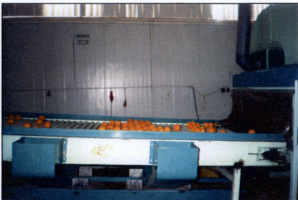
Φωτογραφία 8: Έξοδος πορτοκαλιών με μεταφορική ταινία από το στραγγιστήριο και είσοδος στο κηρωτήριο
