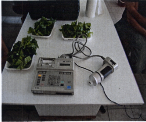
Εικόνα 10. Χρωματόμετρο Minolta CR-300 και προσδιορισμός χρώματος κομμένου μαρουλιού.
