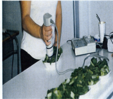
Εικόνα 10. Χρωματόμετρο Minolta CR-300 και προσδιορισμός χρώματος κομμένου μαρουλιού.
