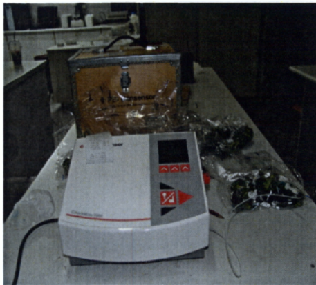
Εικόνα 7. Συσκευή Check Mate 9000 για μέτρηση εσωτερικών αερίων.
