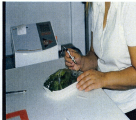
Εικόνα 7. Συσκευή Check Mate 9000 για μέτρηση εσωτερικών αερίων.
