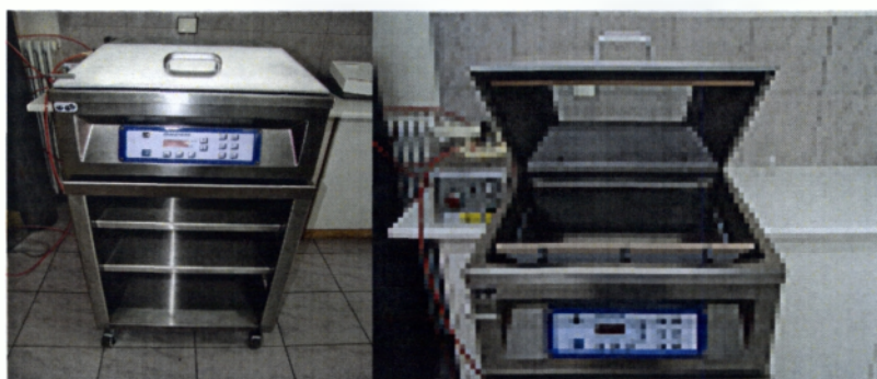
Εικόνα 5. Κλειστική μηχανή Multivac type A300/16
