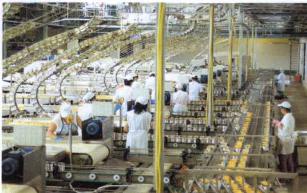
ΕΙΚΟΝΑ 3.6 ΕΠΕΙΤΑ ΤΗΣ ΠΛΗΡΩΣΕΩΣ ΟΔΗΓΟΥΝΤΑΙ ΣΕ ΜΗΧΑΝΗΜΑ ΠΛΗΡΩΣΗΣ ΣΙΡΟΠΙΟΥ ΚΑΙ ΑΠΕΡΩΣΗΣ ΚΑΙ ΣΦΡΑΓΙΣΗΣ ΤΟΥ ΠΕΡΙΕΚΤΗ.
