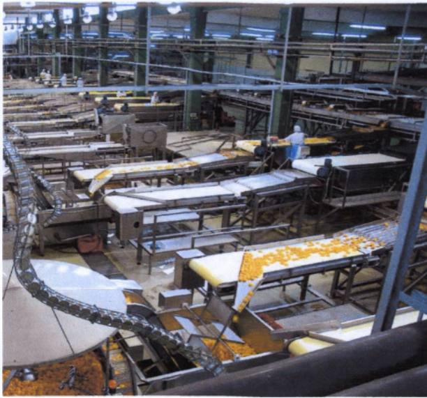
ΕΙΚΟΝΑ 3.5 ΔΙΑΧΩΡΙΣΜΟΣ ΚΑΡΠΩΝ ΣΕ ΠΟΙΟΤΗΤΕΣ ΚΑΙ ΟΔΗΓΗΣΗ ΑΥΤΩΝ ΣΕ ΜΗΧΑΝΗΜΑΤΑ ΠΛΗΡΩΣΗΣ ΚΟΥΤΙΩΝ.
