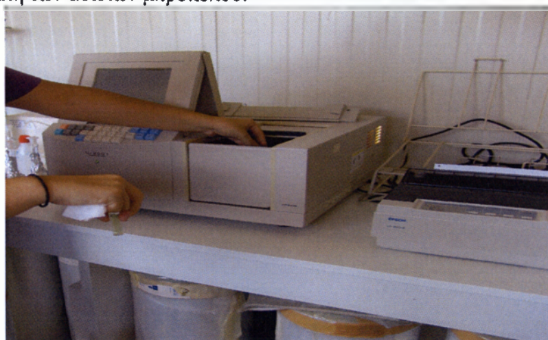
Εικόνα 7β. Προσδιορισμός της περιεχόμενης χλωροφύλλης των ανθιδίων μπρόκολου με το φασματοφωτομέτρο.
