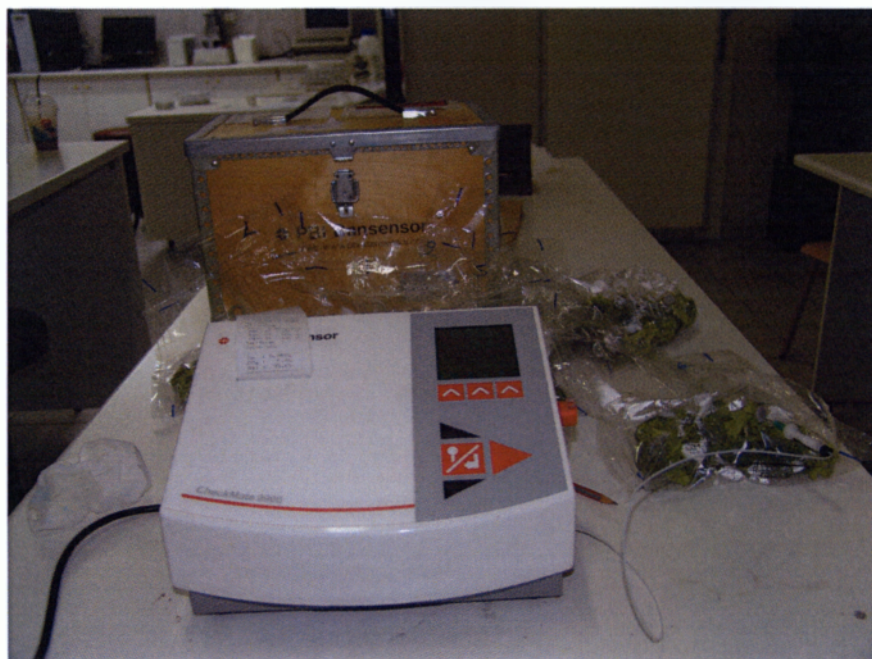
Εικόνα 3. Φορητός αναλυτής για τον προσδιορισμό της μεταβολής της σύνθεσης της ατμόσφαιρας εντός των συσκευασιών PE.
