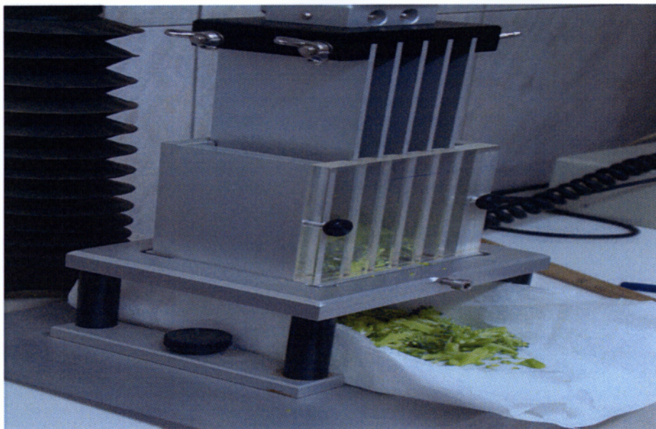
Εικόνα 8α. Προσδιορισμός της μεταβολής της σκληρότητας (υφής) των ανθιδίων μπρόκολου με το όργανο Texture analyzer (TAXT2i).
