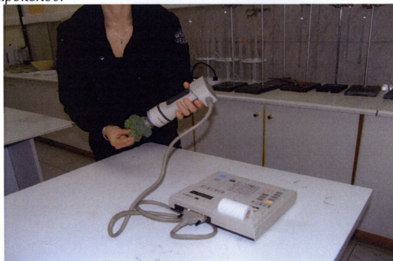
Εικόνα 6α. Χρωματόμετρο Minolta για τον προσδιορισμό του χρώματος των ανθιδίων μπρόκολου.
