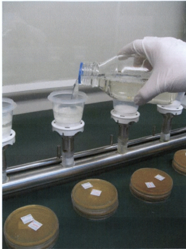
Εικόνα 2. Μέθοδος διήθησης με μεμβράνες (Membrane Filtration).
