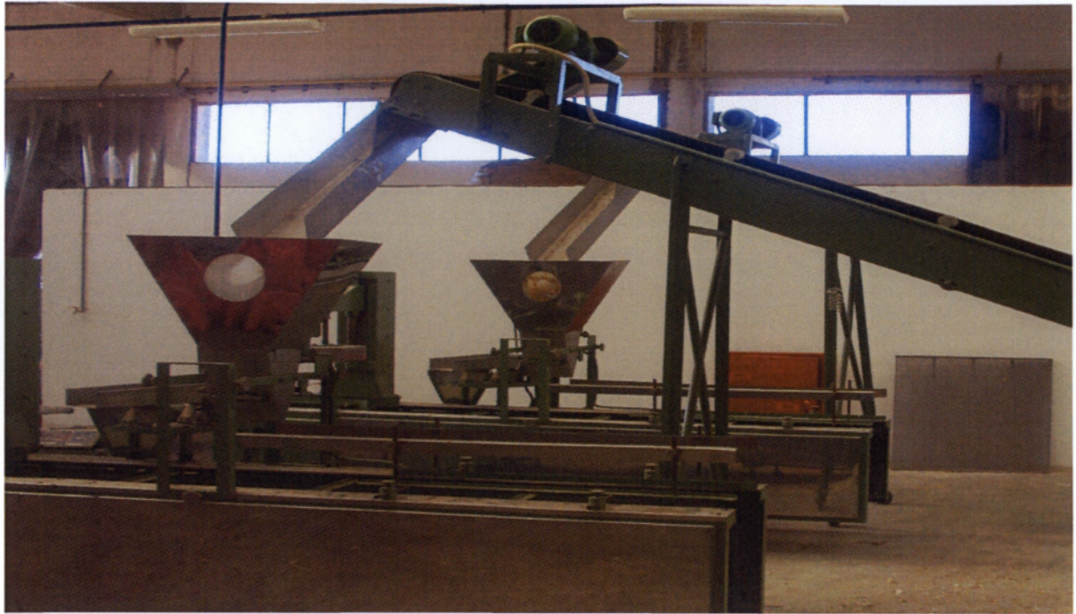
Εικ. 21: Προώθηση σταφίδας στην αυτόματη ζυγιστική μηχανή της Ε.Α.Σ. Μεσσηνίας
