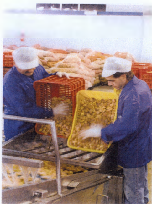
Εικόνα 2.6.: Γραμμή παραγωγής ΣΥΚΙΚΗΣ χοάνη υποδοχής, αναβατόριο, πρόπλυση
