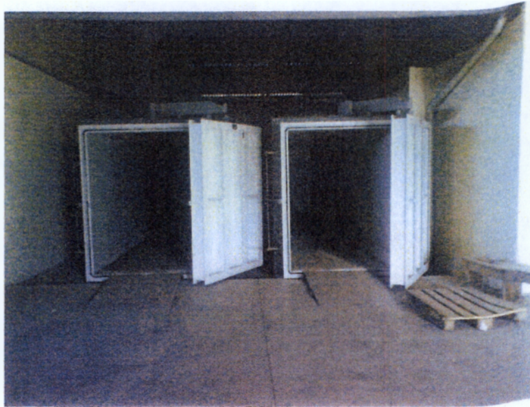
Εικόνα 2.11.: VACUUM τύπου κοντέινερ όπου γίνεται η απεντόμωση
