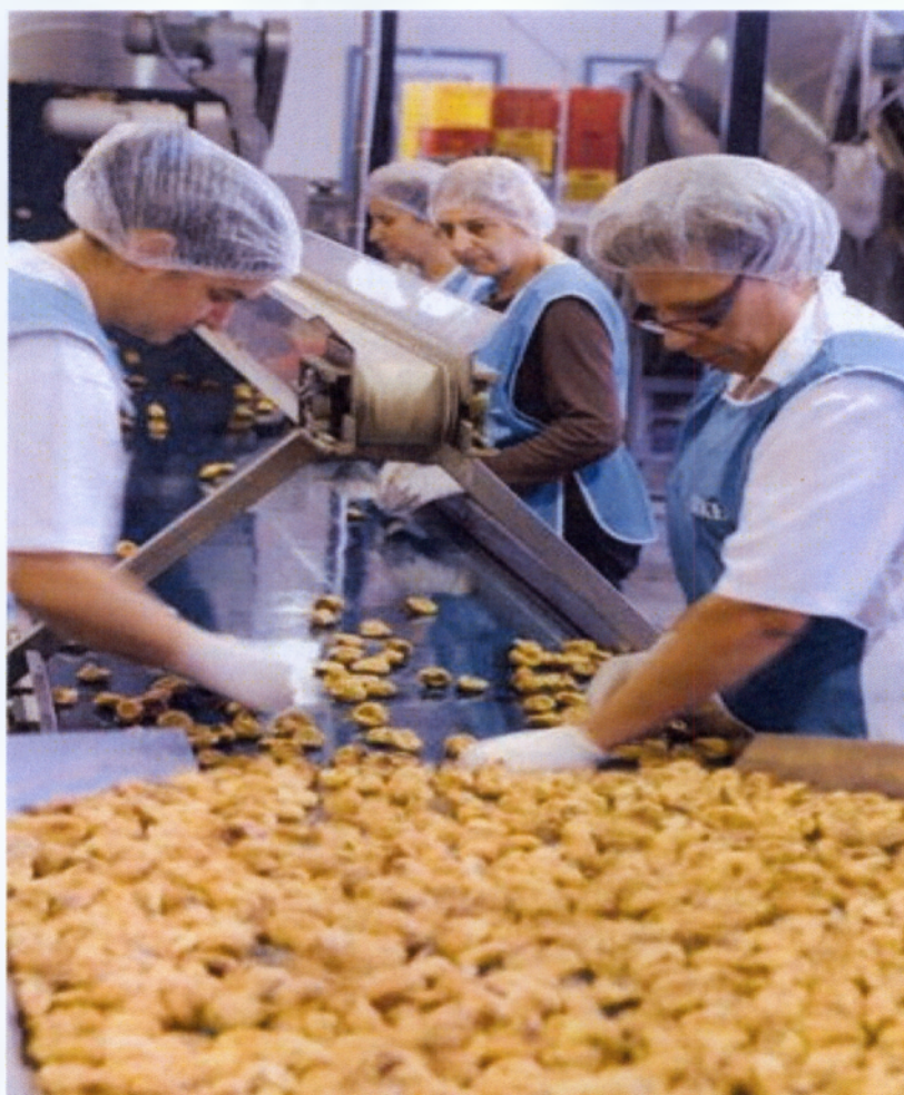
Εικόνα 2.7.: Γραμμή παραγωγής ΣΥΚΙΚΗΣ διαλογέας με κόσκινα, ταινία μεταφοράς
