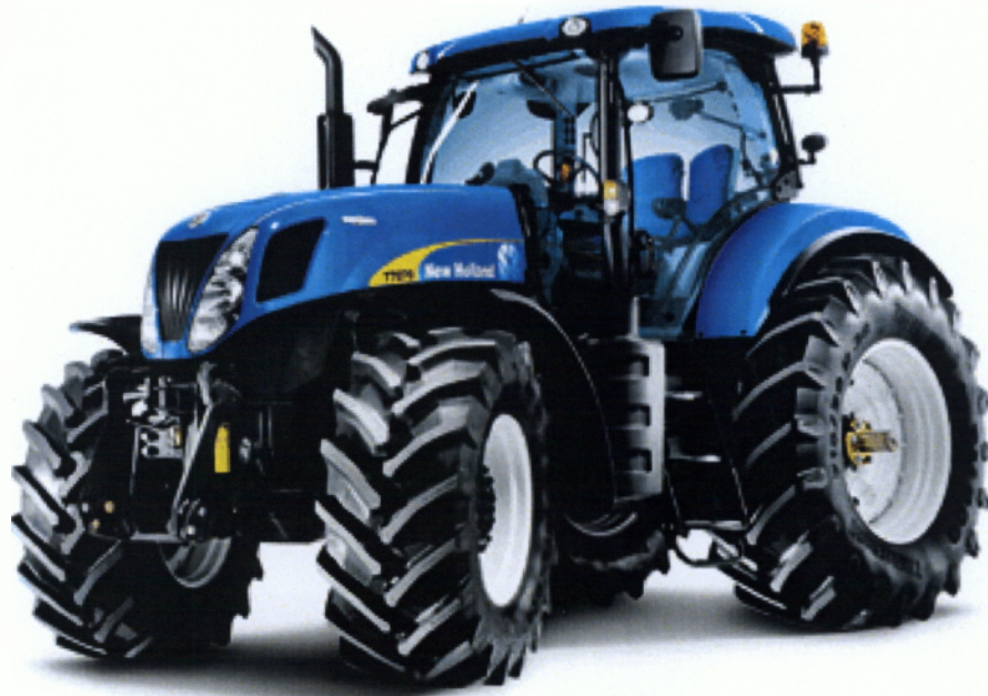
Εικόνα 22. New Holland με τέσσερις κινητήριους τροχούς ( http://www.sts.gr/151/article_1549.aspx 10/05/2011, 09:45)
