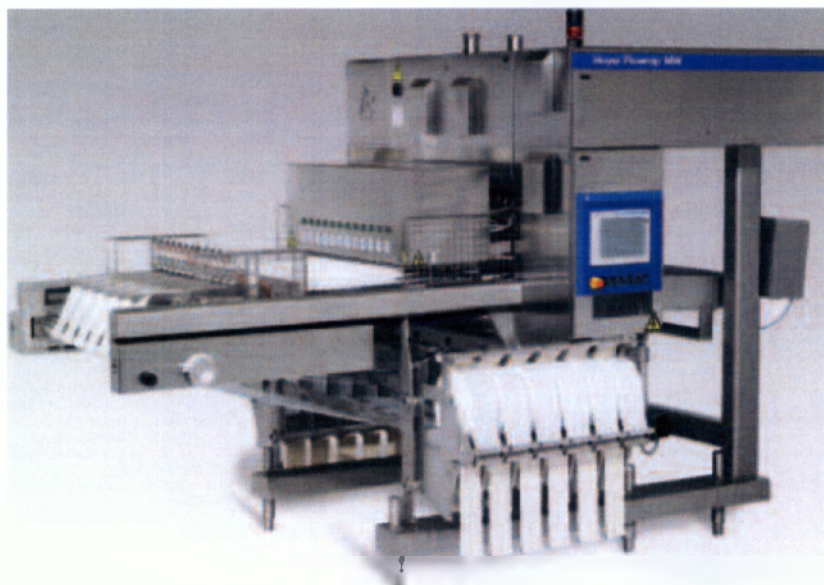
Φωτογραφία 8: HoyerFlowrapSW για παραγωγή sandwich παγωτού
