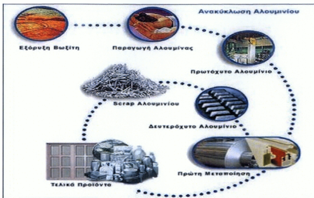
Σχήμα 3.1.: Κύκλος ζωής του αλουμινίου και τα στάδια ανακύκλωσής του.
