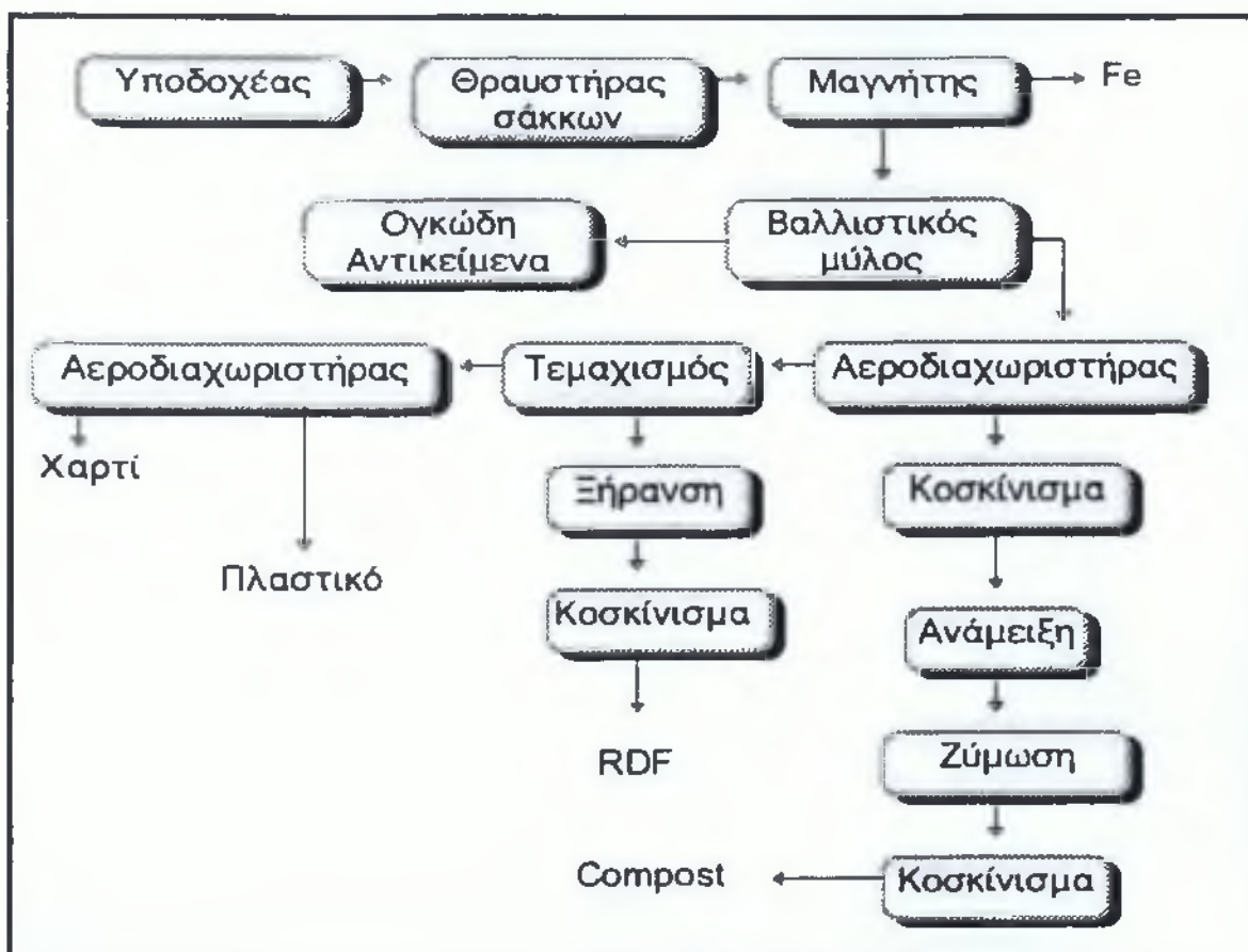
Σχήμα 1.2: Σχήμα ροής τοπικής μονάδας μηχανικής επεξεργασίας ΑΣΑ
