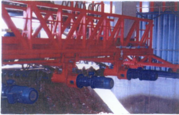
Αναδευτήρας (αναμειγνύει το υλικό)
