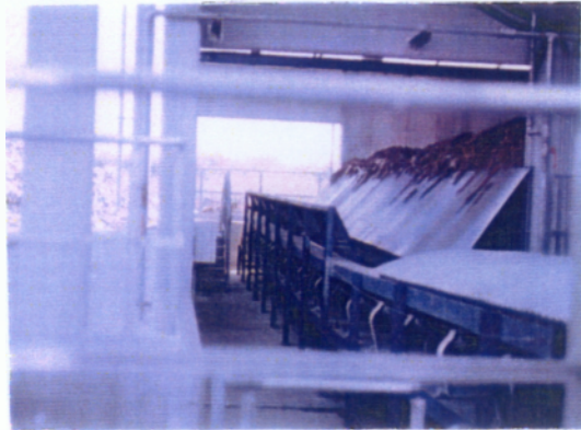
Ο διάδρομος που οδηγεί το υλικό μέσα στο εργοστάσιο όπου ακολουθεί η διαδικασία του Αεροδιαχωρισμού
