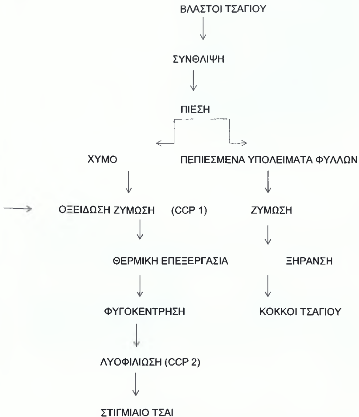
Σχήμα 3: ΔΙΑΔΙΚΑΣΙΑ ΚΑΙ ΔΙΑΓΡΑΜΜΑ ΡΟΗΣ ΓΙΑ ΤΗΝ ΑΜΕΣΗ ΠΑΡΑΣΚΕΥΗ ΤΣΑΓΙΟΥ (Sinija et.all., 2007).
