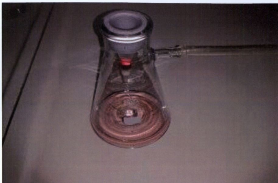
Εικόνα 3. Δείγμα ερυθρού οίνου διηθείται από το puritox στην κωνική φιάλη κενού.
