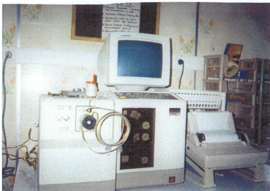
Φωτογραφία 2. Αέριος χρωματογράφος Perkin Elmer 8700.
