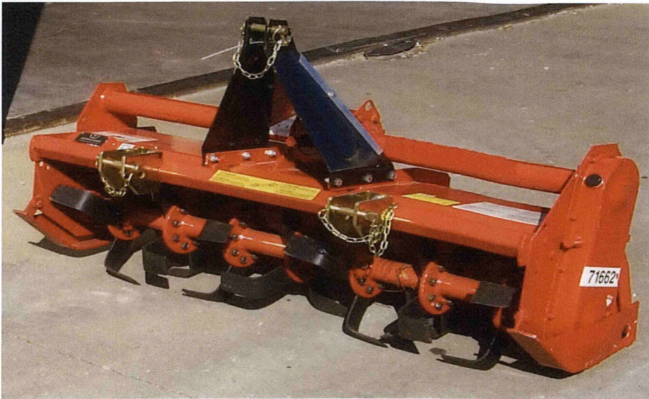
Εικ. 3.13. Φερόμενο περιστροφικό σκαπτικό (φρέζα)
