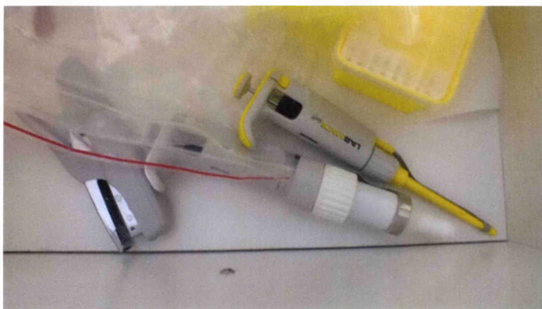
Εικ.18. Σύριγγες τύπου Eppendorf για την παρασκευή του διαλύματος του εντομοκτόνου (D1+D2) (©M. Mavroforos)
