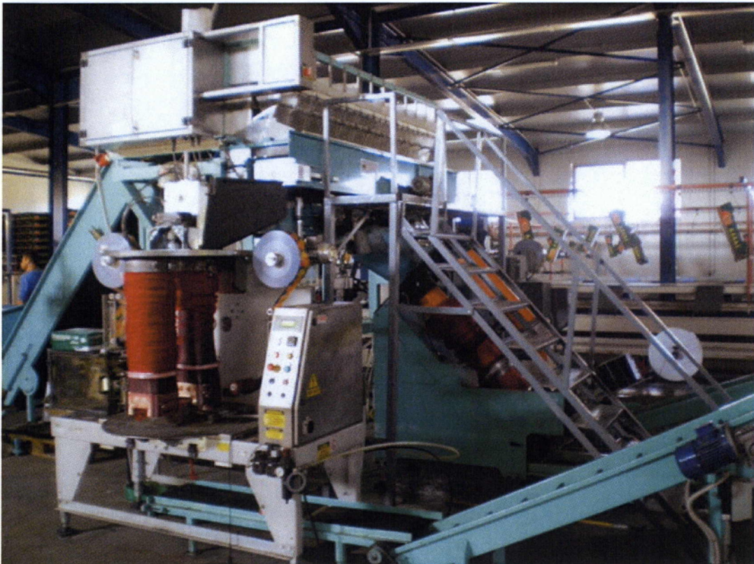
Εικόνα 11: Μηχανή μικροσυσκευασίας πορτοκαλιών σε διχτάκι(1,2,3kg.)
