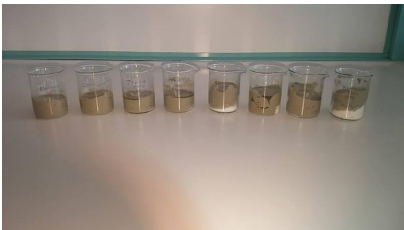
Εικόνα 18: Προσθήκη Ζεόλιθου σε εκχυλίσματα για δοκιμές αποχρωματισμού με συγκεντρώσεις 100%, 130% και 150% σε ποτήρια ζέσεως των 50 ml
