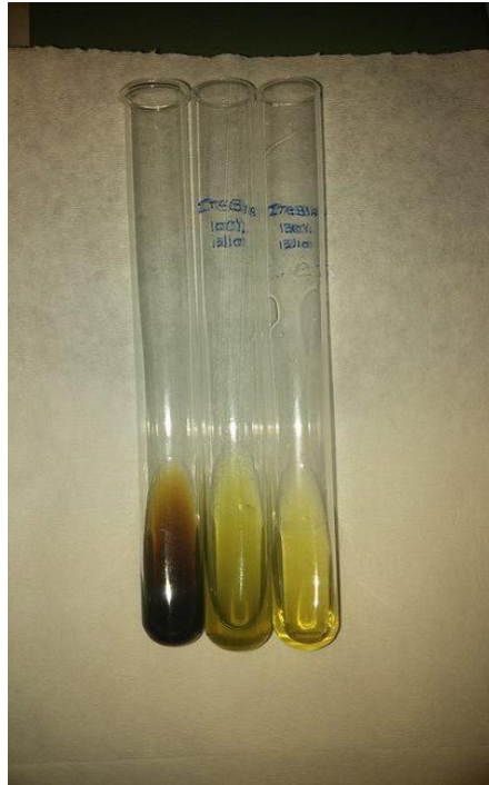
Εικόνα 21: Εκχύλισμα στέβιας μη αποχρωματισμένο (αριστερά) αποχρωματισμένα δείγματα σε διαφορετικές συγκεντρώσεις ζεόλιθου 0% (αριστερά) 100% (μέση) 130% (δεξιά).
