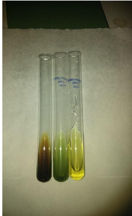
Εικόνα 23: Εκχύλισμα στέβιας-βασιλικού μη αποχρωματισμένο (αριστερά) αποχρωματισμένα δείγματα σε διαφορετικές συγκεντρώσεις ζεόλιθου 0% (αριστερά ) 100% (μέση) 130% (δεξιά).
