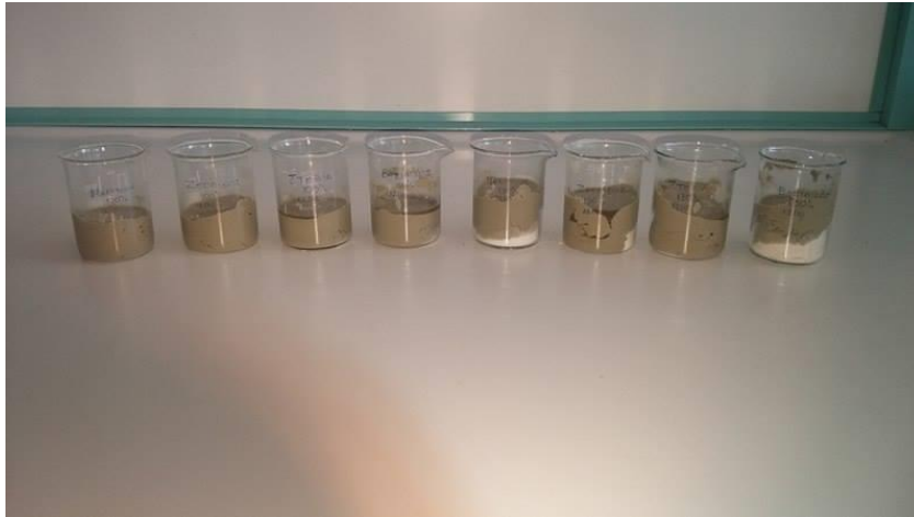
Εικόνα 14: Προσθήκη Ζεόλιθου σε εκχυλίσματα για δοκιμές αποχρωματισμού με συγκεντρώσεις 100%, 130% και 150% σε ποτήρια ζέσεως των 50 ml
