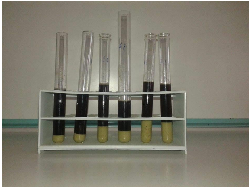
Εικόνα 13: Προσθήκη Ζεόλιθου σε εκχυλίσματα για δοκιμές αποχρωματισμού με συγκεντρώσεις 10-90% σε δοκιμαστικούς σωλήνες των 10ml
