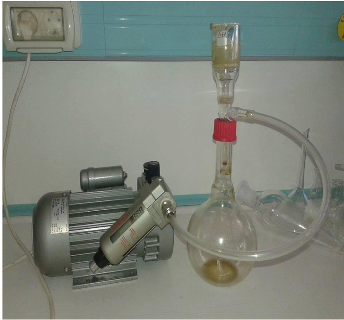
Εικόνα 15: Μηχάνημα διήθησης υπο κενό Büchner σε λειτουργία
