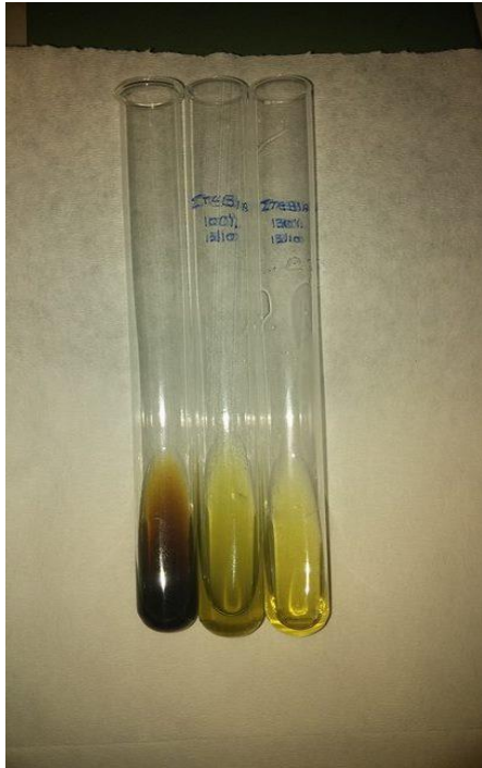
Εικόνα 17: Εκχύλισμα στέβιας μη αποχρωματισμένο (αριστερά) αποχρωματισμένα δείγματα σε διαφορετικές συγκεντρώσεις ζεόλιθου 0% (αριστερά) 100% (μέση) 130% (δεξιά).
