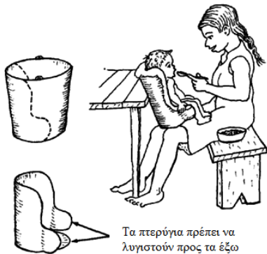
Εικόνα 3.4. Τροποποίηση πλαστικού κουβά για σταθερή θέση σίτισης
