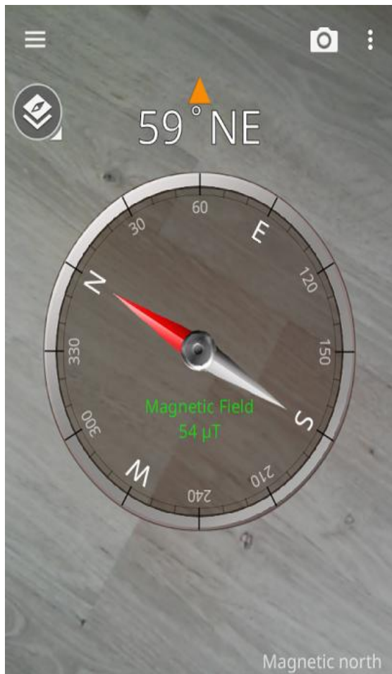
Εικόνα 2.7: Χρήση μίας ηλεκτρονικής πυξίδας μίας συσκευής που δουλεύει με τον αισθητήρα μαγνητόμετρου https://play.google.com/store/apps/details?id=com.maxcom.magdetector&hl=CONFIG_lang
