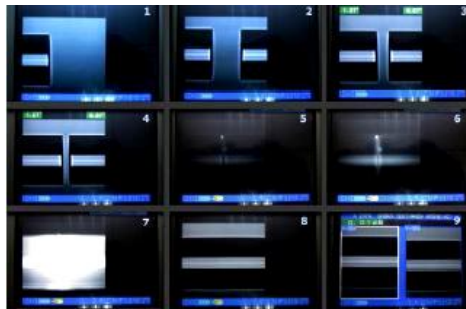
Εικόνα 33: Διαδοχικά στιγμιότυπα της οθόνης του fusion splicer από τα στάδια συγκόλλησης της οπτικής ίνας.
