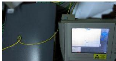
Εικόνα 57: Μέτρηση με κάμψη της οπτικής ίνας.
