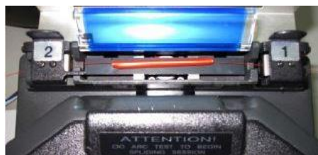
Εικόνα 36: Η θυρίδα εφαρμογής των θερμοσυστελλόμενων σωληνίσκων.
