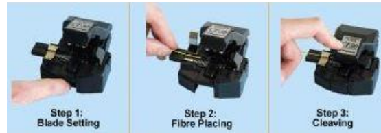
Εικόνα 30: Τα βήματα της διαδικασίας κοπής της οπτικής ίνας [12] .
