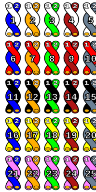
Εικόνα 2: Κώδικας χρωμάτων 25 ζευγών παροχικού τηλεφωνικού καλωδίου Cat6 [3] .
