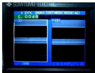
Εικόνα 35: Συγκόλληση οπτικής ίνας με εκτιμώμενη απώλεια 0.00db.
