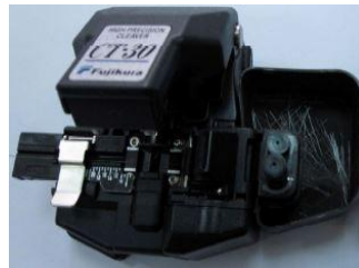
Εικόνα 31: Το μηχάνημα υψηλής ακρίβειας κοπής οπτικών ινών της FUJIKURA.
