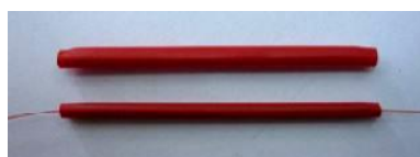
Εικόνα 37: Ο θερμοσυστελλόμενος σωληνίσκος πριν και μετά την κόλληση.
