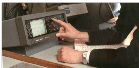
β. δέκτης συστημάτων GPS, NAVSAT/ TRANSIT, OMEGA, LORAN-C και DECCA
