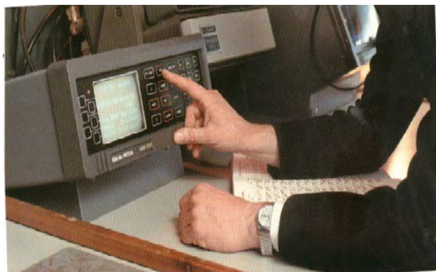
Σύνθετος δέκτης συστημάτων GPS, NAVSAT/ TRANSIT, OMEGA, LORAN-C και DECCA
