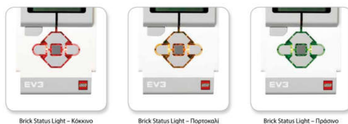
Εικόνα 2.10 Καταστάσεις Λειτουργίας EV3 Brick
