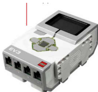
Εικόνα 2.9 Τουβλάκι EV3 (Brick EV3)
